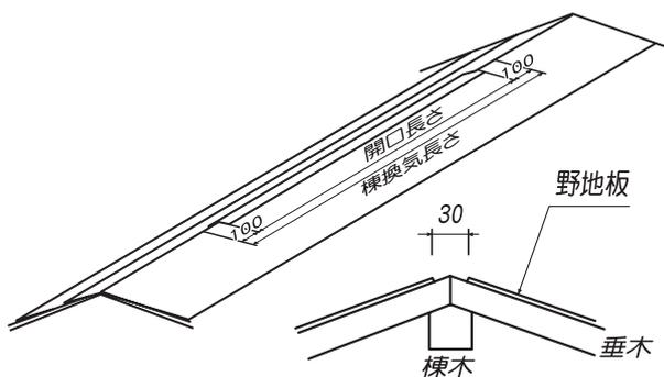
2. 横葺材の開口部施工例
